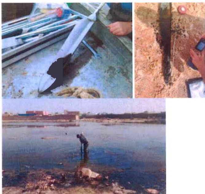
Images 6, 7 et 8 (de gauche à droite). Barrena rusa usada para el muestreo y caracterización de sedimento, Extracción de sedimentos en la mare de Taazour.
