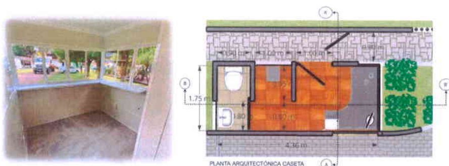
Images 34 et 35 (de gauche à droite). Exemple d'aménagement intérieur d'une cabine de surveillance avec fenêtres offrant une grande visibilité. Photo : grupolacadena.mx . À droite, exemple de plan architectural d'un post de surveillance. © BAREC.
