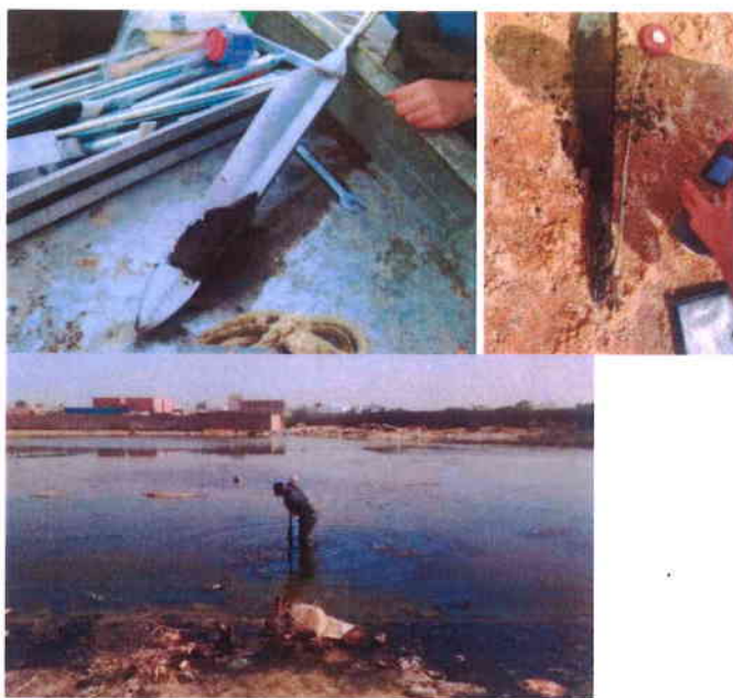
Images 1 et 2 y 3 (de gauche à droite). Tarière russe utilisée pour l'échantillonnage et la caractérisation des sédiments. Extraction de sédiments dans la mare de Tarhill.
